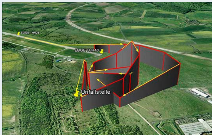
Diffuser Flugweg: Aufgrund einer Herzrhythmusstörung wurde der Pilot nach dem Start bewusstlos und verlor die Kontrolle über das Flugzeug.
